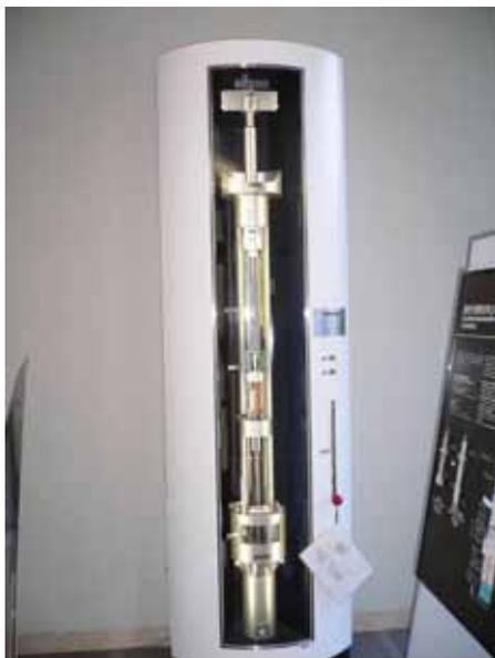
左は改良型沸騰水型原子炉の炉内の再循環ポンプ
